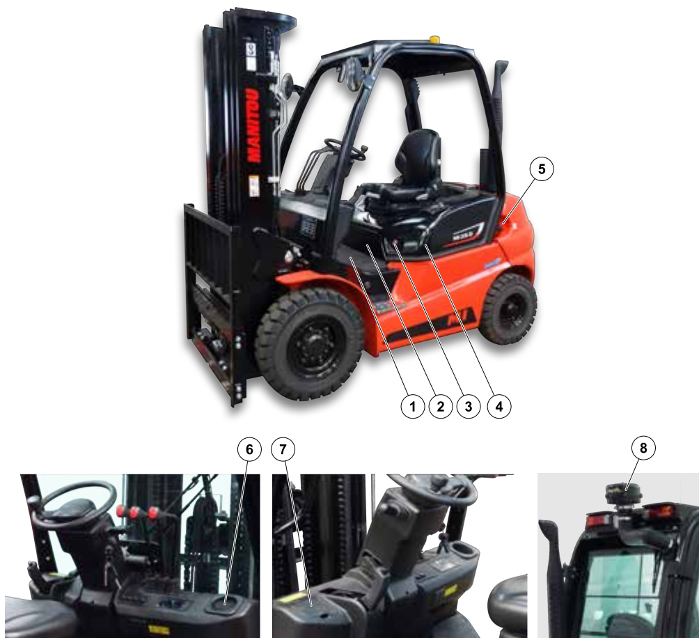
Figur 33: Placering af vedligeholdelseskomponenter - MI 20→35 DK ST5 S1
