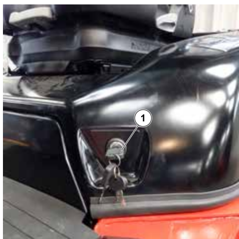
Figur 35: Nøgle i motordæksellås
