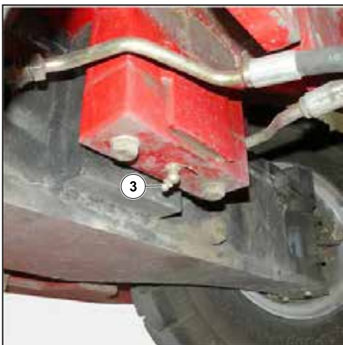
1.3. Smørenipler på bagakselsvinger (2 smørenipler).
